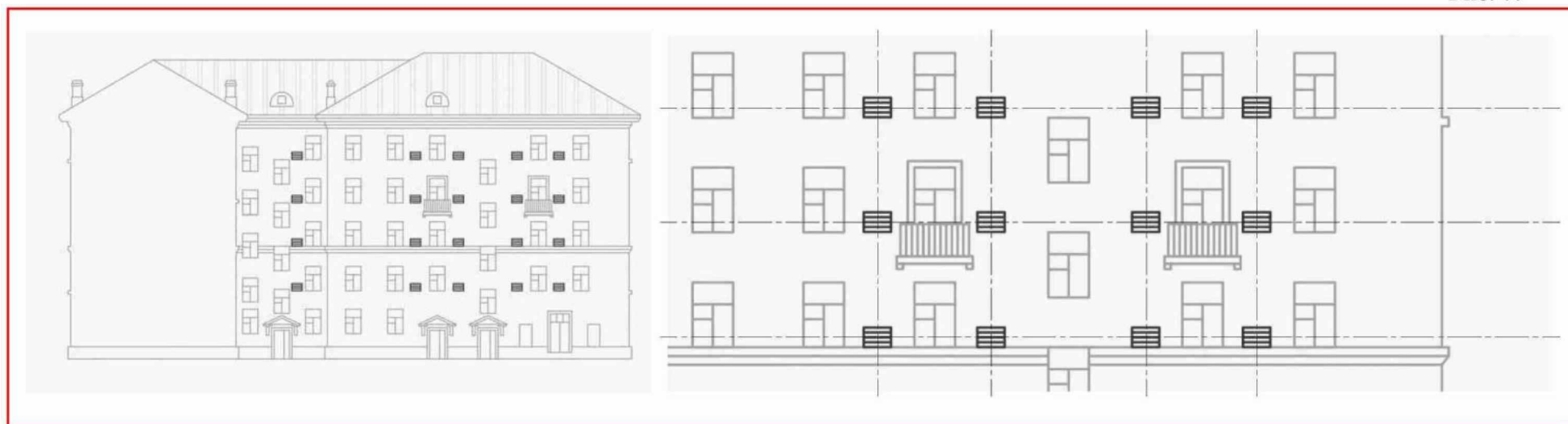
Пример правильного размещения кондиционеров на внутривором фасаде
