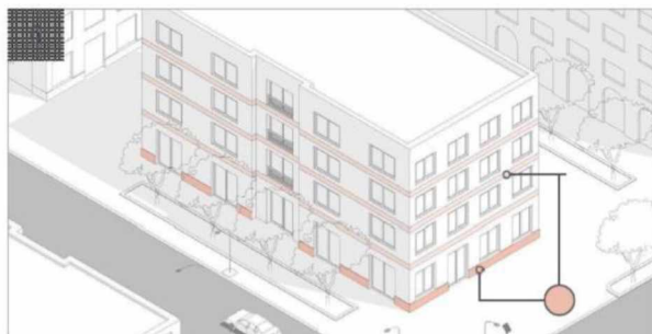
Цоколь в тон перекрытий
